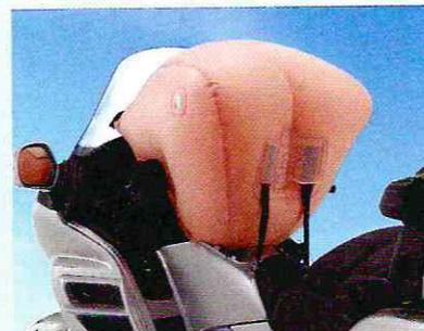
Bei einer Frontalkollision füllt sich der Airbag in 30 Millisekunden mit 150 Litern Stickstoff.
